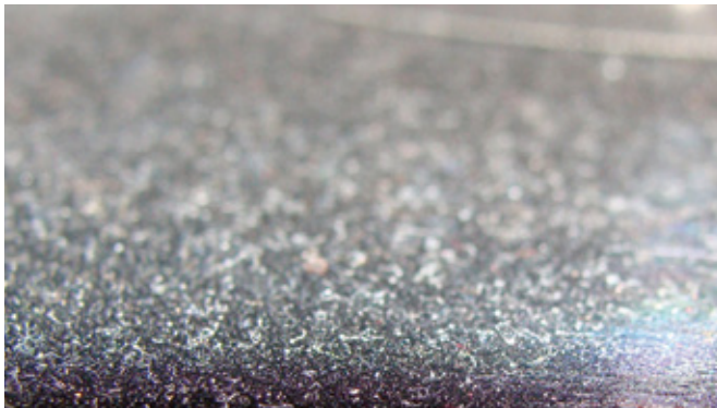
Staubpartikel auf einer aufgeladenen Kunststoffoberfläche Dust particles on a charged plastic sheet
