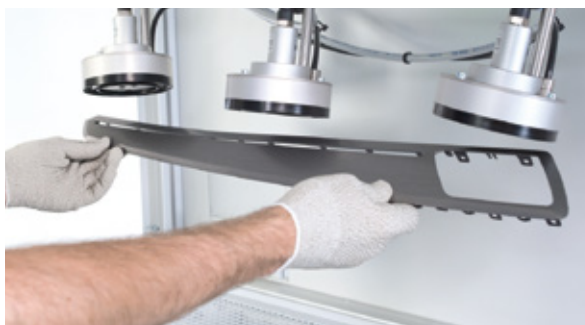
Berührungslose Reinigung mit pulsierendem Druckluft-Wirbel (Reinigungskopf TAIFUN-CLEAN COMPACT) Contactless cleaning with pulsating compressed turbulent air (TAIFUN-CLEAN COMPACT)
